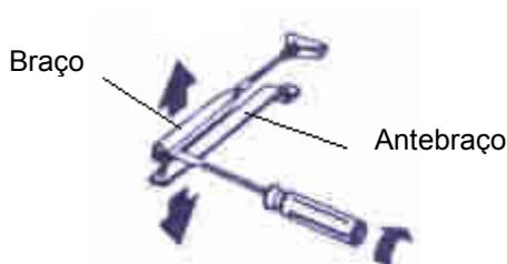
5- Faça a fixação do antebraço na mola, utilizando o parafuso e uma chave de boca de 10mm, o parafuso deverá ser bem apertado para que o antebraço não fique com folga no eixo da mola. **Atenção**, nas instalações normais, as válvulas de regulagem devem ficar para o lado das dobradiças da porta.
