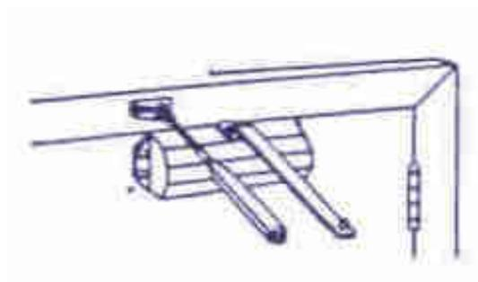
7- Com as peças já fixadas, fazer o encaixe entre o braço e o antebraço, verifique que o braço deverá permanecer à 90° no momento do encaixe, movimentar o antebraço até o ponto de encaixe do braço, caso a distância entre os pontos seja desigual, movimente a rosca do braço para aumentá-lo ou diminuí-lo, até o encaixe.
