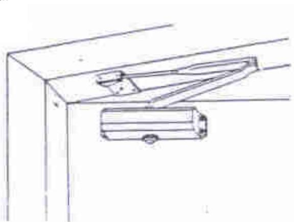
10- A mola já está montada, fazer apenas a regulagem de velocidade, de acordo com a necessidade do cliente. Para um fechamento mais rápido, gire as válvulas com uma chave de fenda para esquerda, para um fechamento mais suave, gire as válvulas para direita.
