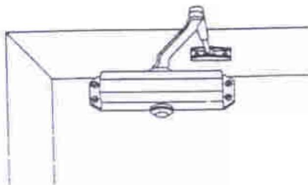
9- Quando necessário á instalação do braço em paralelo ao batente, utilizar o suporte conforme desenho. Atenção neste caso, os parafusos de regulagem das válvulas para a direita.
