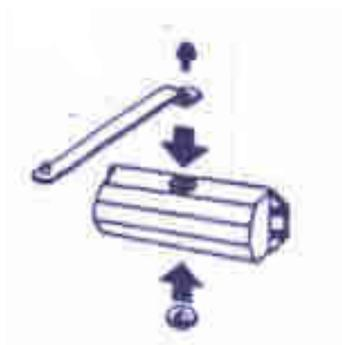
6- Fazer a fixação da mola na folha da porta, utilizando os parafusos do Kit. Em seguida faz-se a fixação do braço no batente.
